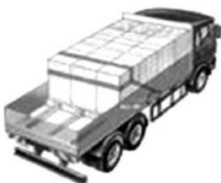
Rys. 5. Mocowanie przez nałożenie czołowe za pomocą zawiesia
